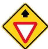
PROXIMIDAD DE SEÑAL "CEDA EL PASO"
